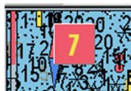
Lorsque générer une nouvelle visualisation de la carte prend 6 secondes ou plus, un indicateur apparaîtra dans le coin gauche en haut de la zone de la carte. Il montre combien d'heure en secondes le système a travaillé sur le nouveau système de visualisation de la carte. Cet indicateur apparaîtra seulement quand les cartes avec une très haute densité d'information sont utilisées.
