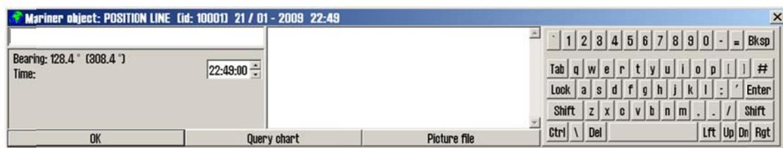
**Lignes de point multiples, Zones:** Les prochains boutons en-dessous de la ligne de position permettent d'ajouter des lignes multipoint, et des surfaces multipoints rectangulaires et circulaires. Les informations supplémentaires sont gérées de la même façon que pour la ligne de position. De plus, le remplissage des zones peut basculer grâce à la case "Remplir" dans cette fenêtre.
