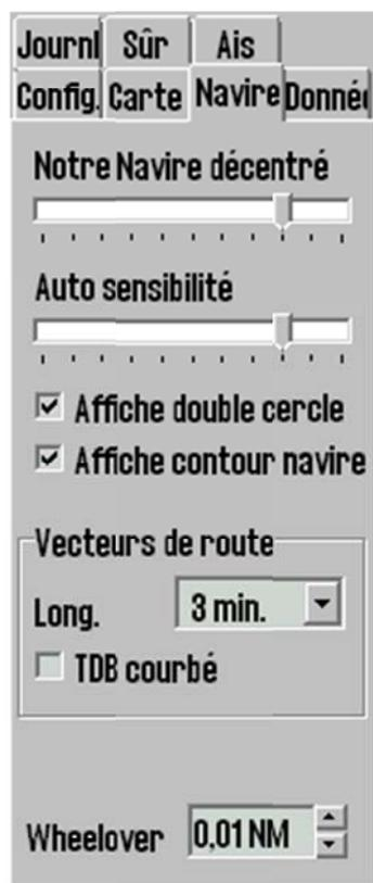
Dans toutes les orientations des cartes, sauf “*Cap*”, la carte est fixée à l'écran, alors que le vaisseau bougera (mouvement réel). Avec l'orientation “*Cap*”, le vaisseau aura une position fixe sur l'écran, alors que la carte changera (mouvement relatif).
