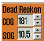
Si les systèmes secondaires et primaires tombent en panne simultanément, le mode de navigation à l'estime est activé automatiquement. La navigation à l'estime peut aussi être activée manuellement par saisie des Lignes de Position (Voir Chapitre 5.6). Les données du journal de bord et du gyro sont utilisées si disponible, autrement les données doivent être saisies manuellement. Utilisez la touche "S" pour fixer la position au centre de la carte.
