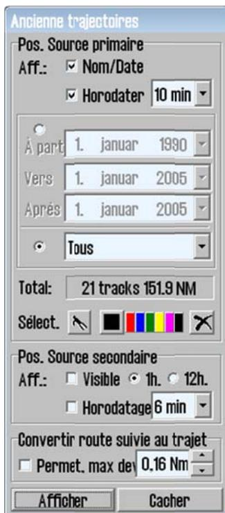
La deuxième zone permet à l'opérateur de sélectionner la visibilité des trajectoires de capteur de position secondaires et de basculer entre la dernière heure ou les 12 dernières heures de trajectoires secondaires. Ces trajectoires peuvent, de même, être affichées avec l'horodatage à un intervalle de temps sélectionné.
