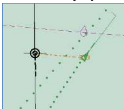
Figur 1: "CAM"-symbolet låst til et ARPA- eller AIS mål
